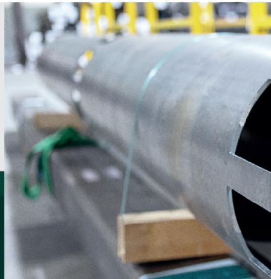
CMM vanta una divisione per il taglio laser di tubi, tubolari e profili in acciaio di prima importanza a livello europeo. L'esperienza di CMM inizia nel 1998 con l'installazione della prima macchina e continua con una crescita esponenziale: oggi l'azienda è dotata di 9 impianti laser di ultima generazione in grado di tagliare tubi con diametro minimo di 12 mm e fino ad un massimo di 610 mm.
